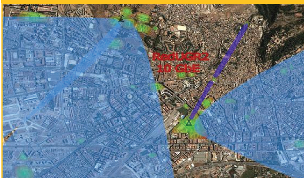
FIGURA 5. EN VERDE ZONAS DE LA CIUDAD DE GRANADA CON COBERTURA 802.11A/B/G. DETALLE DE ESTACIONES BASES WIMAX Y SECTORES DE COBERTURA. LINEAS EN AZUL, DETALLE DE ENLACES PUNTO A PUNTO
